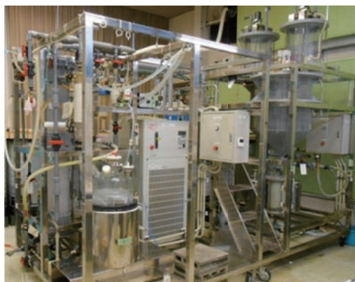
図2. Nd・Dy等回収実証試験装置
